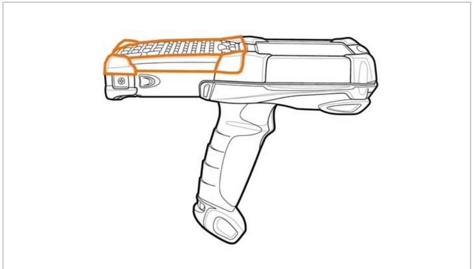
9. Die Tastatur mit den beiden Schrauben am Gerät befestigen.
