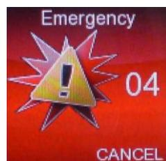
Bevor der Notruf abgesetzt wird, gibt ein Countdown von 10 Sekunden die Möglichkeit, den Vorgang abzubrechen.
