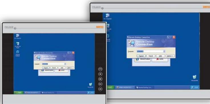
L'écran du POLARIS Web Client/Remote PC 19,1" est un écran TFT avec une résolution SXGA (1280 x 1024 pixels) et le POLARIS Web Client/Remote PC 15" avec une résolution XGA (1024 x 768 pixels). Ils se caractérisent par une brillance excellente et un angle de lecture très grand.
