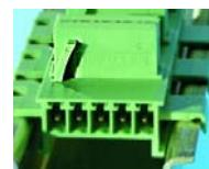
**Hinweis:** um eine Verpolung bei der Installation zu Verhindern, sind die pac-Bus-Elemente mit einer Codierleiste (siehe Foto) und die Module mit dem entsprechendem Codierschlitz versehen.
