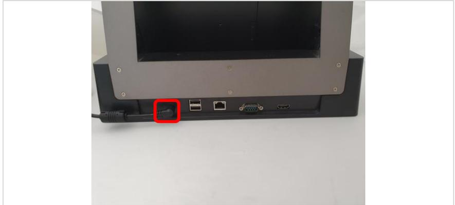
2. Stecken Sie den Bartec Ex-i USB-Stick in die USB-Schnittstelle des Tablet-PC
